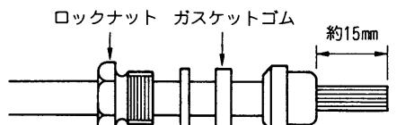
外被を除き、ロックナット、ワッシャ、ガスケットゴムを通し、外部編組をていねいに解く
