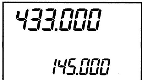
VFOモード、MEMORYモード、CALL CHモード時は、セットしているバンドの周波数を表示します。表示周波数の桁数はバンドにより異なりますが、各バンドとも1KHz桁まで表示します。
