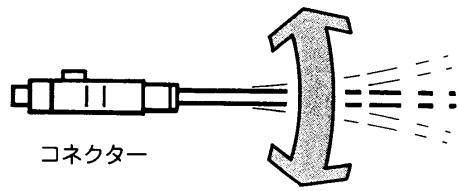
⑤光ファイバーケーブルはインターフェイスAとBを接続するケーブルですが、接続の際、コネクターを差し込んだ上から、必ず付属のロック金具をかぶせておいてください。
