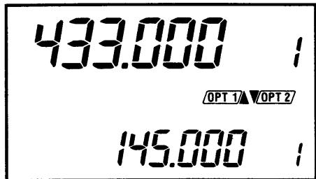
取り付け後、ディスプレイは左図のように点灯します。この表示は、インターフェイスAにオプションが接続されていることを示しています。
