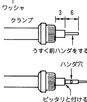
クランプを通して解いた編組を一本並べに広げ、余った編組を切落し、内部絶縁物、中心導線を寸法どおりに切断し、中心導線にうすく前ハンダをしてから中心コンタクトをハンダ付けする
