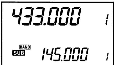
① **SUB**スイッチを押し、**SUB**表示が点灯した状態にします。
