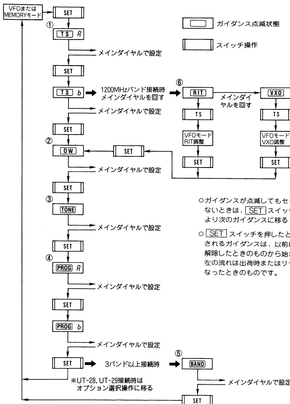
○ガイダンスが点滅してもセットする必要のないときは、[SET]スイッチを押すことにより次のガイダンスに移る
