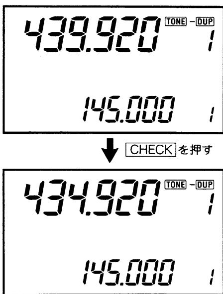
⑪ [CHECK] スイッチを押しますと、送信と受信の周波数が押している間だけ反転します。
