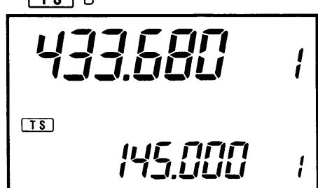
メインダイヤルの周波数ステップを2種類セットすることができます、このスイッチでどちらのステップを使うかを選択します。
